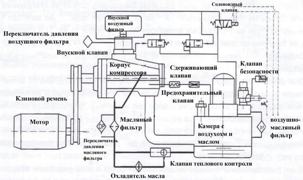
Схема технологического процесса (30 кВт)
